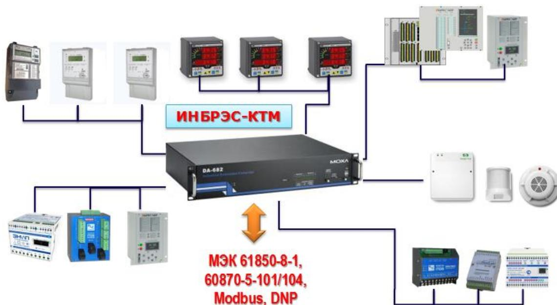
Рисунок 3 – сбор данных устройством ИНБРЭС-КТМ
