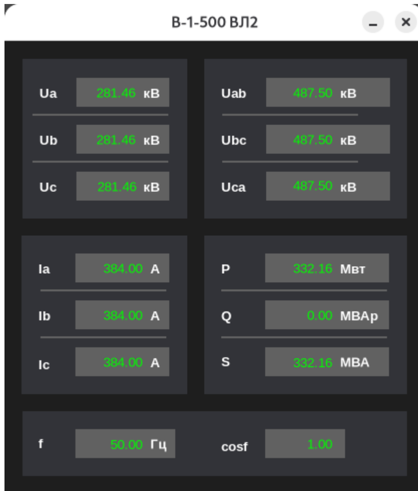
Рисунок 2.22 Мнемосхема отображения аналоговых сигналов
