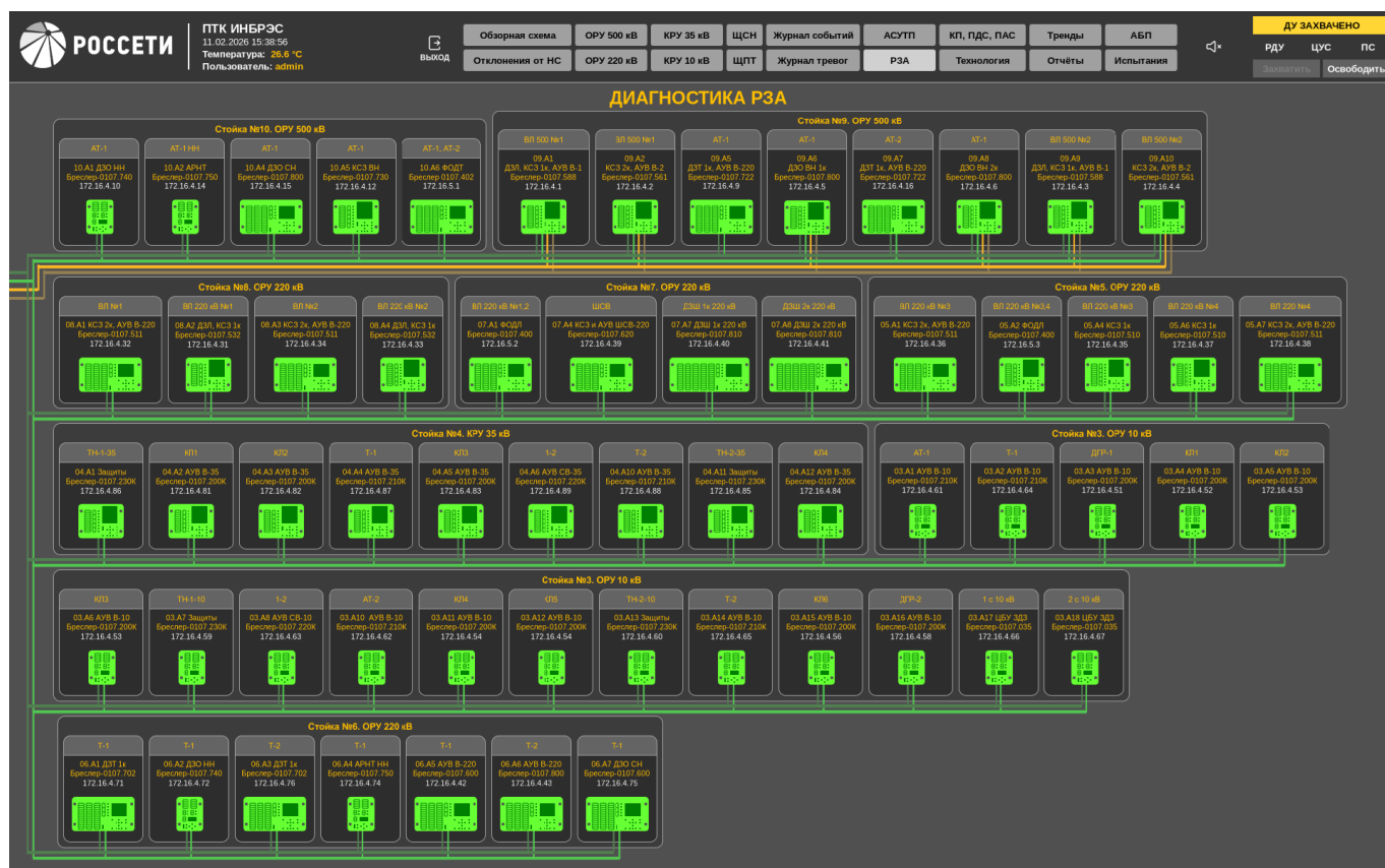
Рисунок 3.6. Пример мнемосхемы диагностики РЗА
